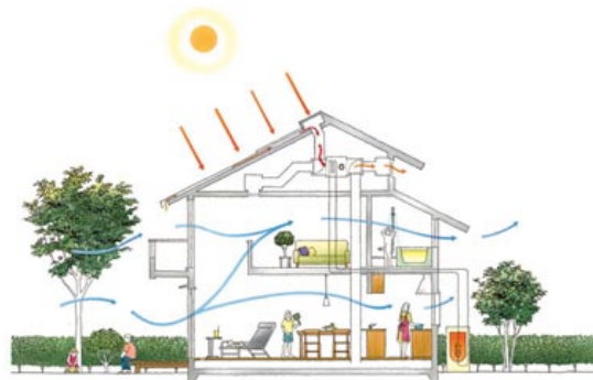
図 2 OMソーラシステムの夏の動作
