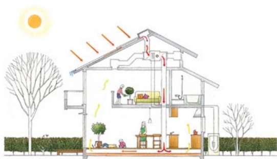
図 1 OMソーラシステムの冬の動作
